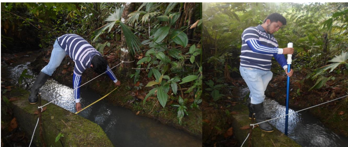
Figura 5. Medición de caudal. Fuente: este trabajo
